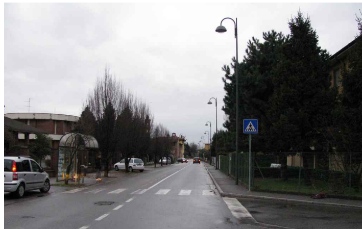
Via Aldo Moro - apparecchi di tipo decorativo equipaggiati con sorgenti ai vapori di sodio ad alta pressione
